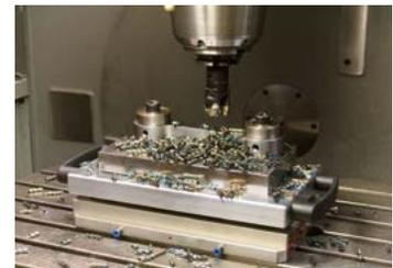
Zweifachspannung mit Spannplatte
